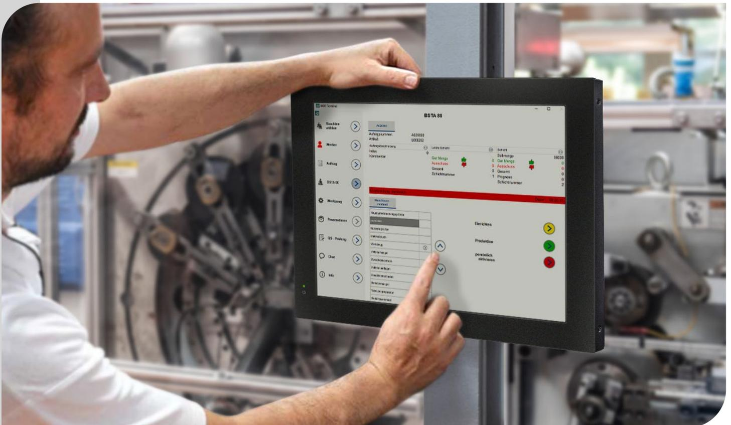
Die **MES-Terminals auf dem Shopfloor erleichtern die Arbeitsweise der Werker**. Sie informieren über **aktuelle als auch geplante Aufträge** und lassen sich dank **selbsterklärender Benutzeroberfläche mit Touch-Screen-Funktion** einfach bedienen. Die Werker sind von Handaufschriften entlastet und haben einen Beleg für ihre Arbeit.
